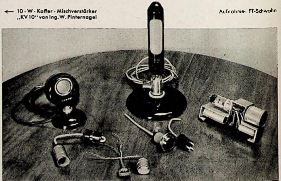
Links: dynamisches Tauchspulenmikrofon „M 27“; Mitte: dynamisches Bändchenmikrofon „M 31b“; im Vordergrund: Kabelsteckerverbindungen und Eingangübertrager; rechts: Vorverstärker (alles Beyer)
